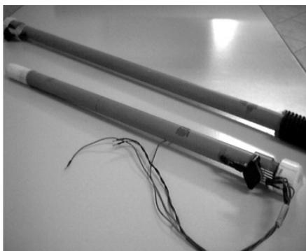
FIGURA 1. Tensiômetro com o sensor
