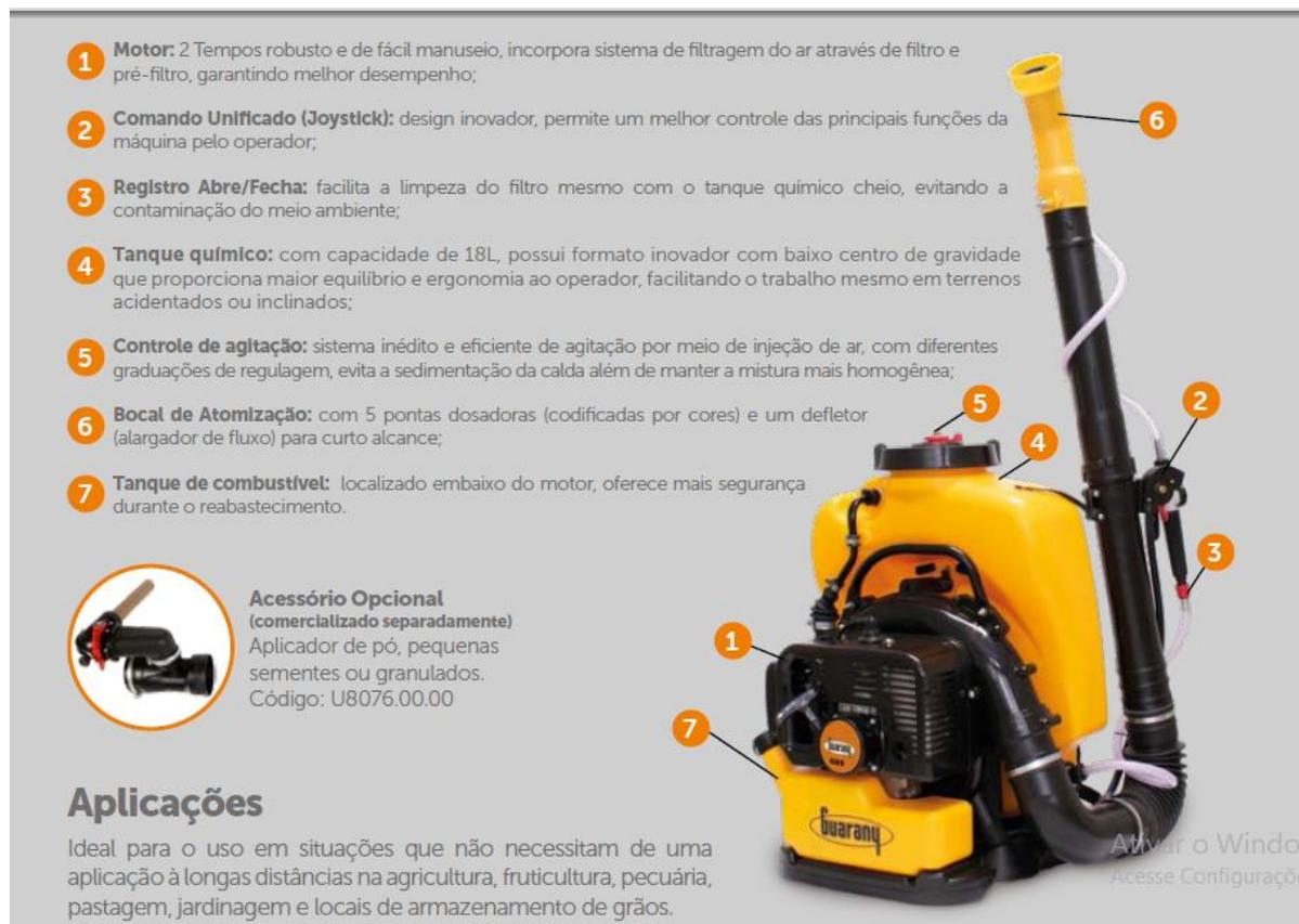
**1 Motor:** 2 Tempos robusto e de fácil manuseio, incorpora sistema de filtragem do ar através de filtro e pré-filtro, garantindo melhor desempenho;
