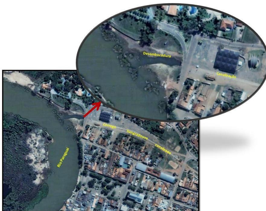
Figura 04 - Imagem onde mostra um dos pontos críticos: travessa da canalização do Córrego Sangradouro e sua desembocadura. Org.: SILVA, M. A (2011).
